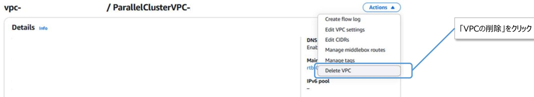
2.5 削除と確認欄に入力し「削除」をクリックするとVPCが削除される。
