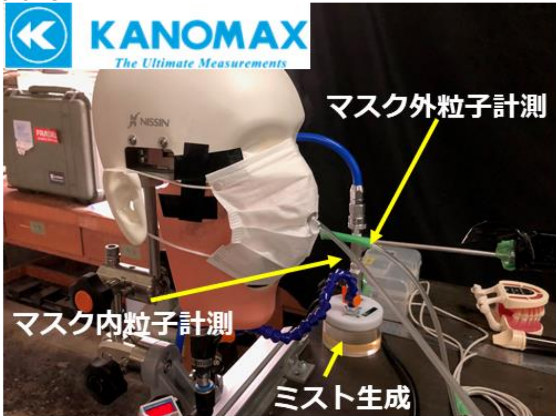
計測装置（カノマックス社製） マスクフィットテスター（吸い込み） Model 3000 パーティクルカウンター（吐き出し・素材透過率） Model 3889
