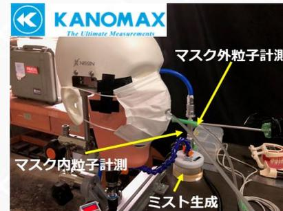
図4 人工口腔モデルを用いた流れ場・粒子計測実験
