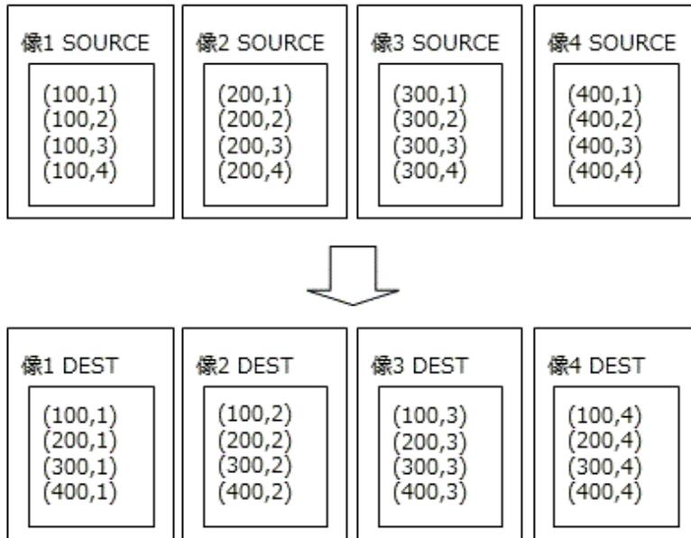
通信相手をずらして通信の衝突を避けると、上例より高速に実行することが期待できます。以下に例を示します。
